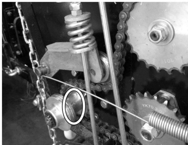
Figura 37 Partea stângă, unger pentru pinionul de transmisie principal
